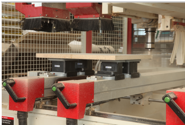
Blocksauger VCBL-K2 beim Aufspannen eines Werkstücks
